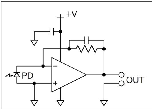
（解説）PDに光が入射するとPDのカソードからアノードに向けて電流が流れます。オペアンプの帰還抵抗により電圧に変換します。
