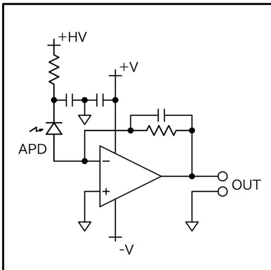
(说明) 光线入射到 PD 时，电流会从 PD 的阴极流向阳极。通过运算放大器的反馈电阻转换为电压。
